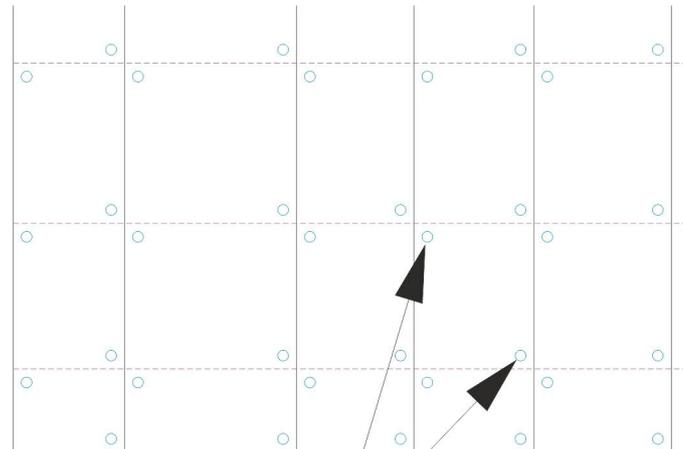
Durch die diagonal angeordneten Verbindungen (Aluminium-Rillenstifte) wird eine äußerst hohe Elementsteife erreicht.
